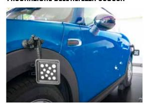
L'utilizzo dei bersagli opzionali per l'altezza scocca appositamente progettati consente di eliminare l'inserimento manuale dei dati, accelerare la misurazione e aumentare la precisione.
